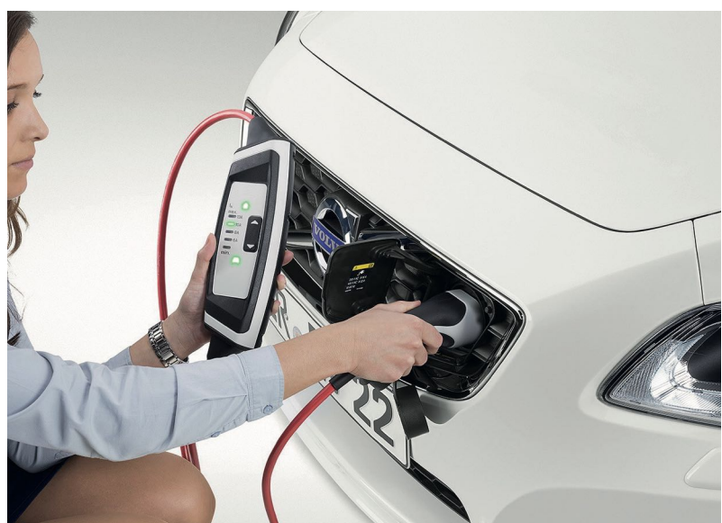
Bild 7: Ladekabel mit Steuer- und Schutzeinrichtung für ein Elektrofahrzeug bei Ladebetriebsart 2 (IC-CPD)
